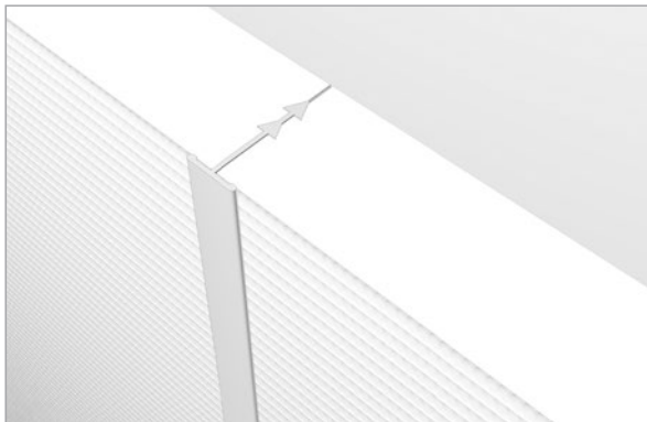
Plattenstoß mit T-Profil
